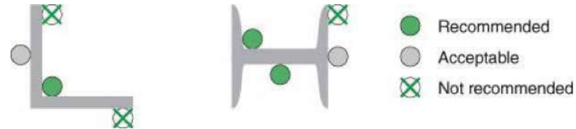
Şekil 3. Çelik kirişlere kabloları yüklemek için öneri (Şekil 4).
